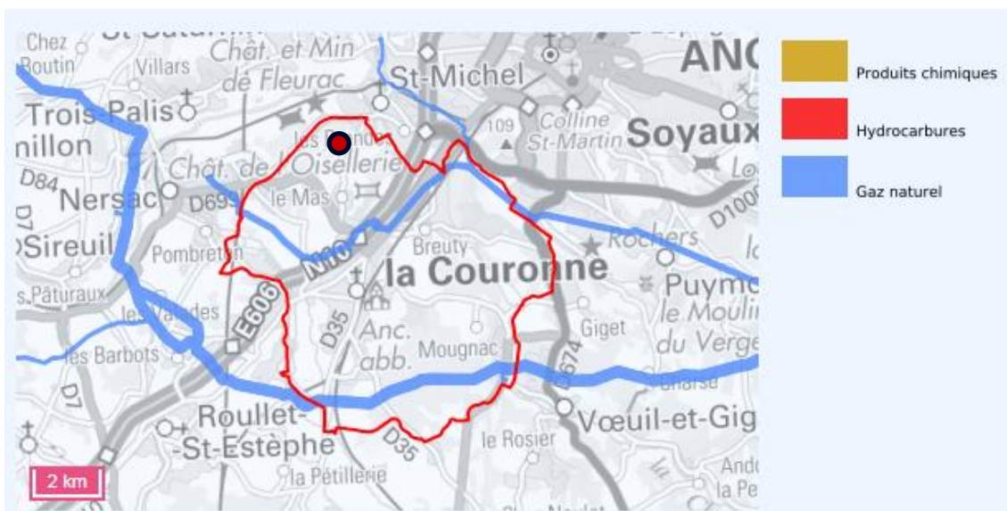
Figure 22 : Cartographie des canalisations de matières dangereuses
